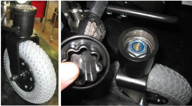
Ziehen/schlagen Sie die Abdeckkappe vorsichtig nach oben weg. Lösen Sie die Sicherungsmutter vollständig und entfernen Sie die Schwenkgabel. Stellen Sie sicher dass Sie die Schwenkgabel mit Schraubensicherung wieder befestigen.
