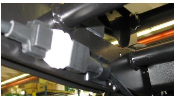
Stecken sie den Joystick- und Lichtstecker aus und entfernen sie den Tilt-Endschalter. Stossen sie die Stecker bzw. die Kabel in Richtung Front aus dem Aktuator Bereich.
