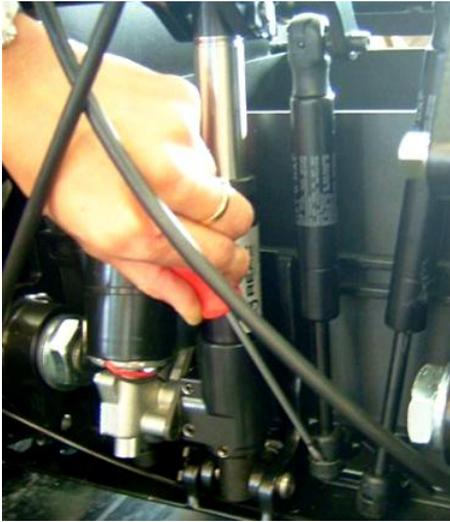
Stellen Sie sicher, dass sich die Sitzkantelung in der obersten Position befindet. Gehen Sie mit einem Schraubenzieher zwischen den Kunststoffkopf und die Metallspange, drücken Sie die Spange einige Millimeter vom Kopf weg aber lassen Sie auf das die Spange nicht wegfliht. Wenn Sie die Spange angehoben haben, sollte es möglich sein die Gasfeder zu entfernen. Wiederholen Sie diesen Vorgang für die andere Seite.
