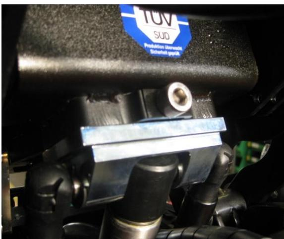
Begeben sie sich seitlich zum Stuhl, links oder rechts und halten den Aktuator in der einen Hand und demontieren sie den Bolzen aus der Kupplung bzw. Basis unterhalb des Sitzes.
