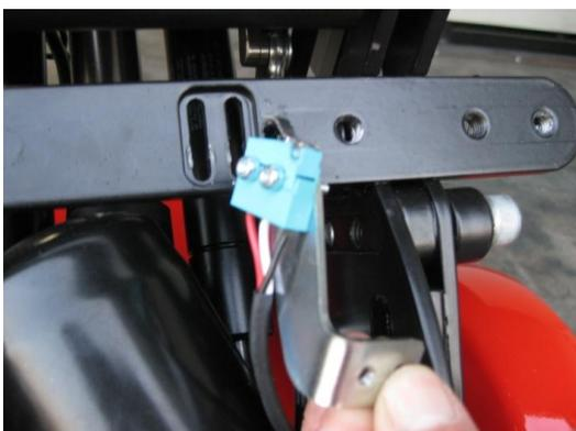
Entfernen sie den Geschwindigkeits-Endschalter.
