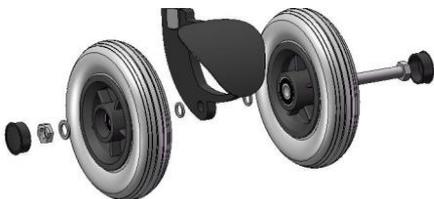
Entfernen Sie die Abdeckkappe in der Mitte des Rades, indem Sie mit einem feinen Schraubenzieher die Kappe anheben, machen Sie das bei beiden Rädern. Lösen Sie die durchgehende Schraube und entfernen Sie nun das abgefahrene Rad. Montieren Sie die Teile wieder in umgekehrter Reihenfolge.
