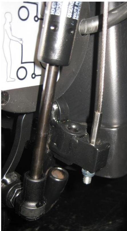
Das Einstellen des Stossdämpfers ermöglicht die feine Abstimmung der Bodenfreiheit des Vorderrades.
