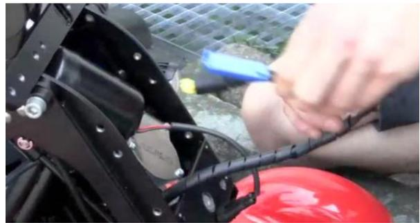
Die Kabel werden dann von vorne auf der linken Seite oberhalb des Aktuator-Antriebes und der linken Gasdruckfeder nach hinten über den Rotationsbegrenzer nach hinten geführt.
