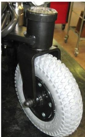
Entfernen Sie die Abdeckkappen des **8" Einzelrades**. Lösen sie die Achse der Schwenkgabel und entfernen Sie nun das abgefahrene Rad. Montieren Sie die Teile wieder in umgekehrter Reihenfolge.
