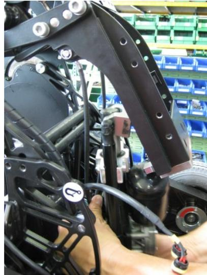
Die Steh-Aktuator Einheit kann nun nach unten ausgebaut werden. Drehen der Einheit kann die Demontage erleichtern. Vergewissern sie sich, dass sich die Radabsenkungskabel hinter der Aktuator Einheit befinden.
