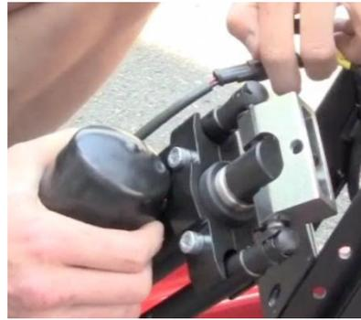
Schliessen sie die Aktuator-Einheit an die Steuerung an und fahren sie diese komplett ein zur kürzest möglichen Länge. Der Stuhl in der maximalen Sitzkantung, erleichtert den Aktuator Einbau von unten.
