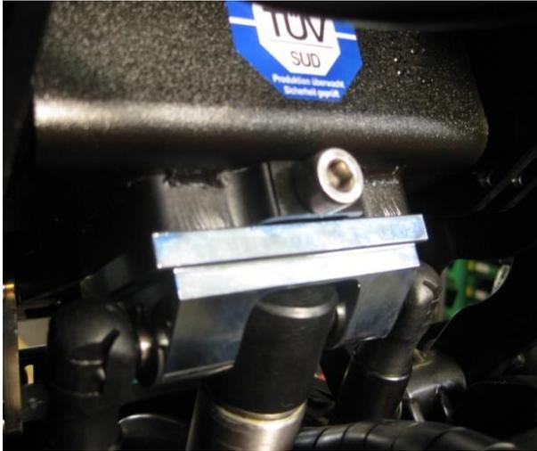
Fahren sie mit dem Aktuator in die Stehposition und ziehen sie den Kupplungsbolzen nach - aber nicht zu stark, damit er später ohne Probleme wieder demontiert werden kann.
