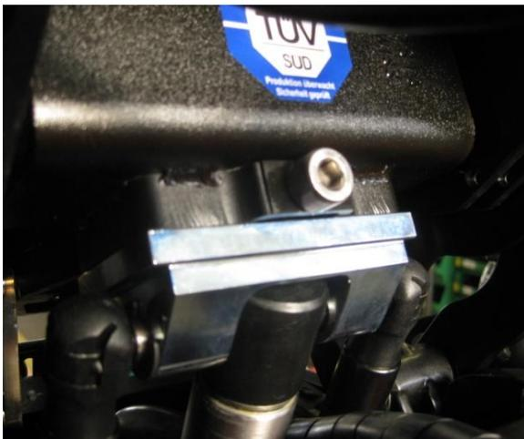
Lösen sie den Kupplungsbolzen der Aktuator-Kupplung unterhalb der Sitzbasis so, dass dieser später von Hand ausgeschraubt werden kann. Vergewissern sie sich, dass der Bolzen aber immer noch mit der Kupplungsbasis verbunden ist.
