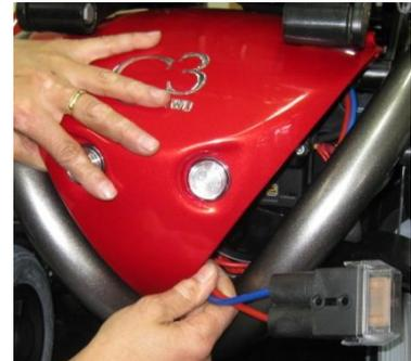
Die Hauptsicherung ist hinten unter der Abdeckung. Öffnen Sie die Abdeckung um an die Sicherung zu gelangen.
