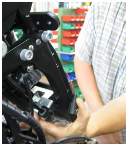
Stellen sie die Steh-Aktuator Einheit in die Beinabstützung ab, sodass sie nicht nach unten rutschen kann.
