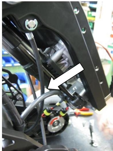
Stossen sie die Aktuator Einheit nach innen gegen die Radabsenkungskabel. Verwenden sie dafür ein Werkzeug um ihre Finger zu schützen.
