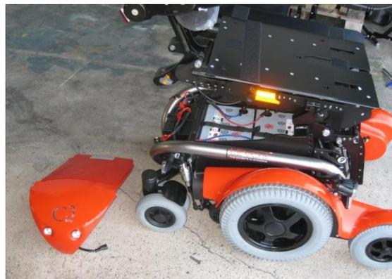
Entfernen und ausstecken der Batterieabdeckung.
