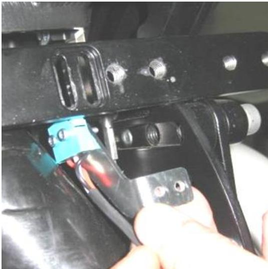
Montage und Einstellung des Geschwindigkeits-Endschalters.
