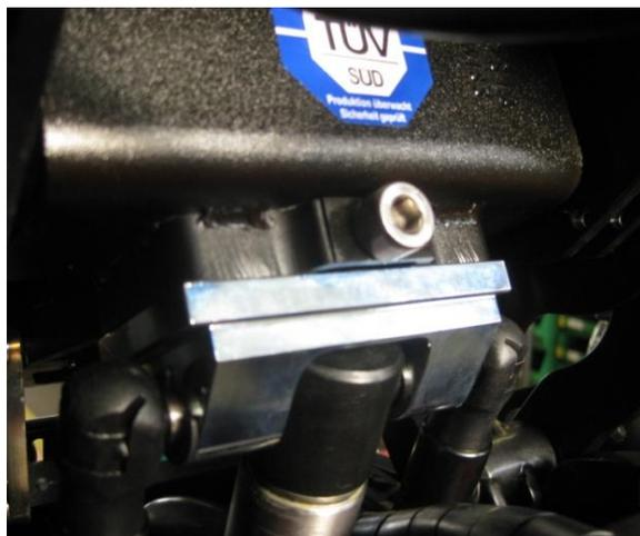
Lösen sie den Kupplungsbolzen der Aktuator-Kupplung unterhalb der Sitzbasis so, dass dieser später von Hand ausgeschraubt werden kann. Vergewissern sie sich, dass der Bolze aber immer noch mit der Kupplungsbasis verbunden ist.
